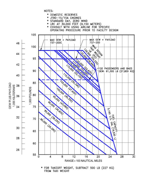
3.2.3 PAYLOAD/RANGE FOR LONG-RANGE CRUISE MODEL ADVANCED 737-200 (JT8D-15/15A ENGINES)
