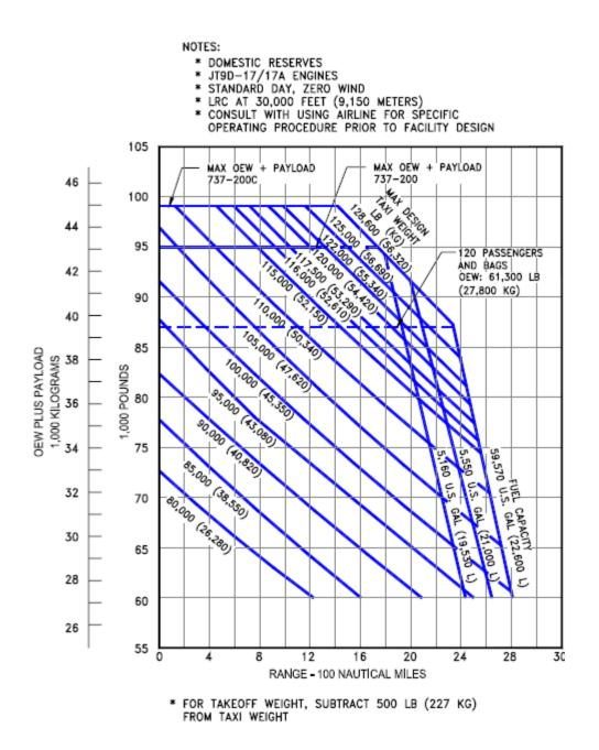
3.2.4 PAYLOAD/RANGE FOR LONG-RANGE CRUISE MODEL ADVANCED 737-200 (JT8D-17/17A ENGINES)
