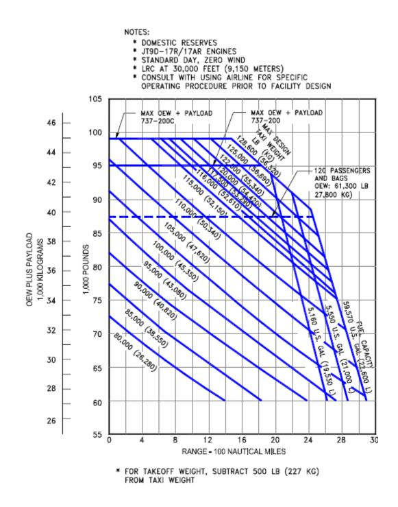
3.2.5 PAYLOAD/RANGE FOR LONG-RANGE CRUISE MODEL ADVANCED 737-200 (JT8D-17R/17AR ENGINES)
