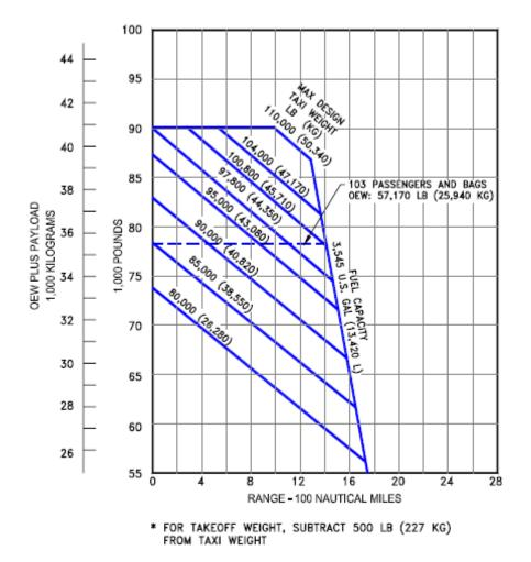
3.2.1 PAYLOAD/RANGE FOR LONG-RANGE CRUISE MODEL 737-100 (JT8D-7 ENGINES)
