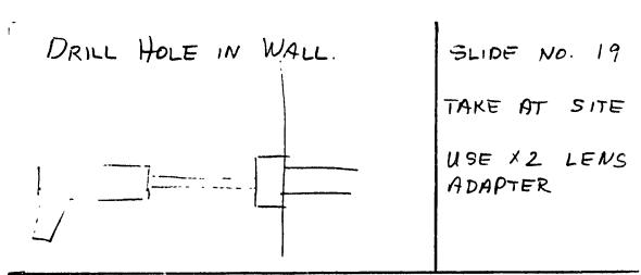
ANEW HOLE OF 22" DIAMETER IS NOW DRILLED IN THE WALL OF THE HOUSE. THE LOCATION IS THE SAME AS THE OLD CONDUIT.
