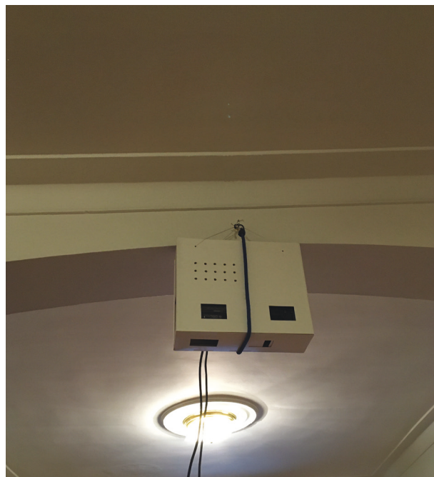
Fig. 33 - Installation du projecteur à l'intérieur de son support
