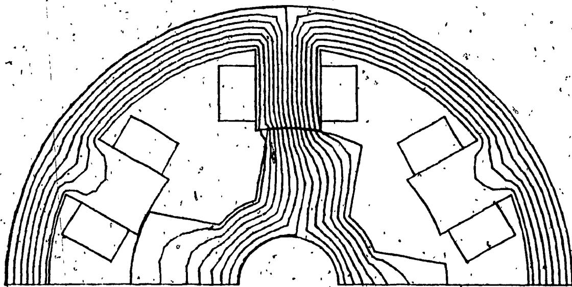
Fig. 3.7 Flux plot. Rotor pole axis at 10 degrées
