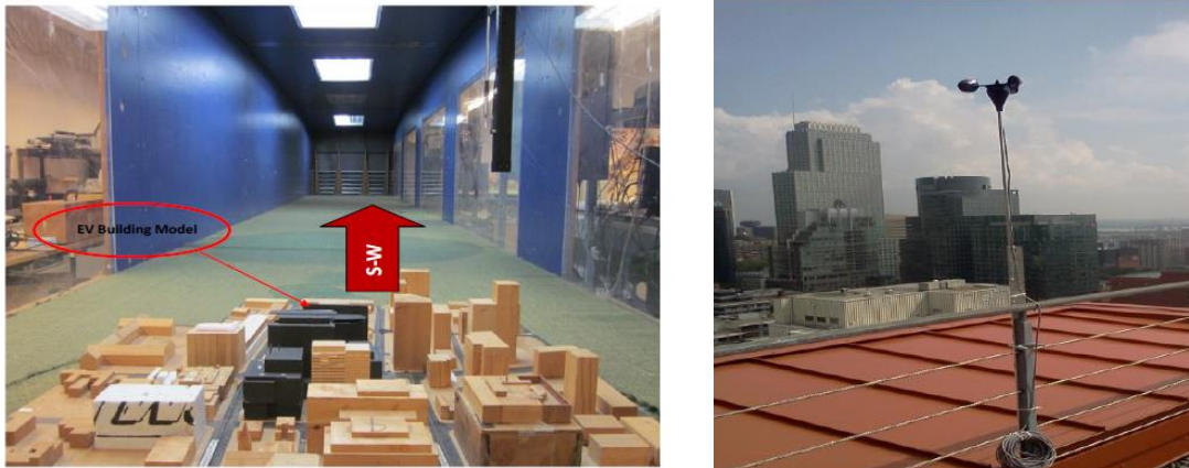
Figure 6. a) Maquette 1:400 du groupe des bâtiments de l'université Concordia et ses bâtiments adjacents. b) Anémomètre sur toit du EV-building de Concordia
