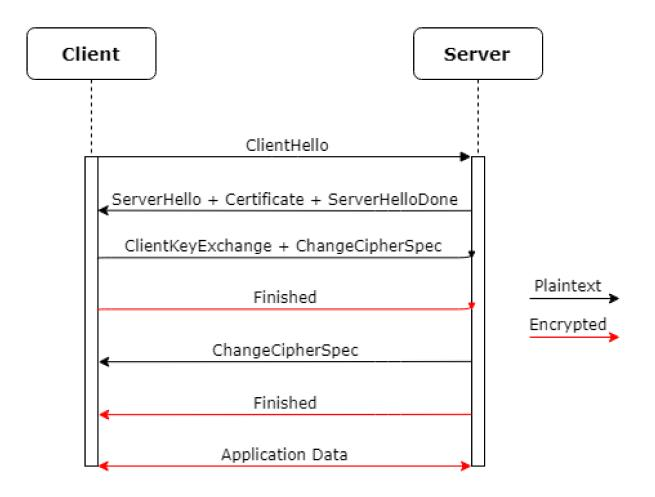
Figure 2.1: TLS Handshake
