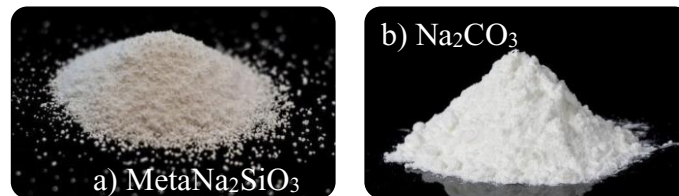
Fig. 19 – Dry-powder activators a) MetaNa 2 SiO 3 b) Na 2 CO 3
