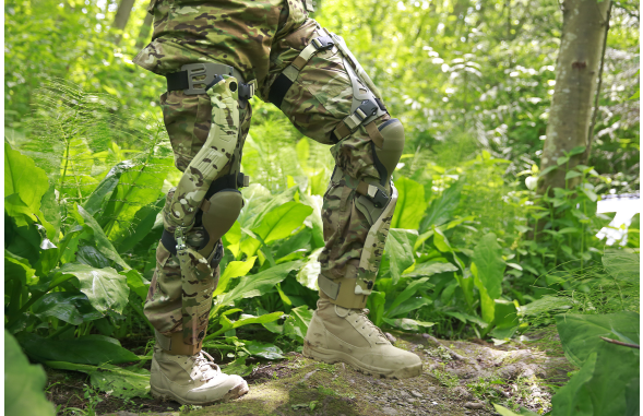
(d) Bionic power knee energy harvester [16]
